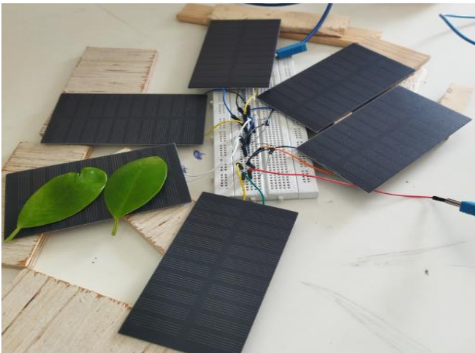
Figure III.10. Image explicative le cas de défaut d'ombrage.
