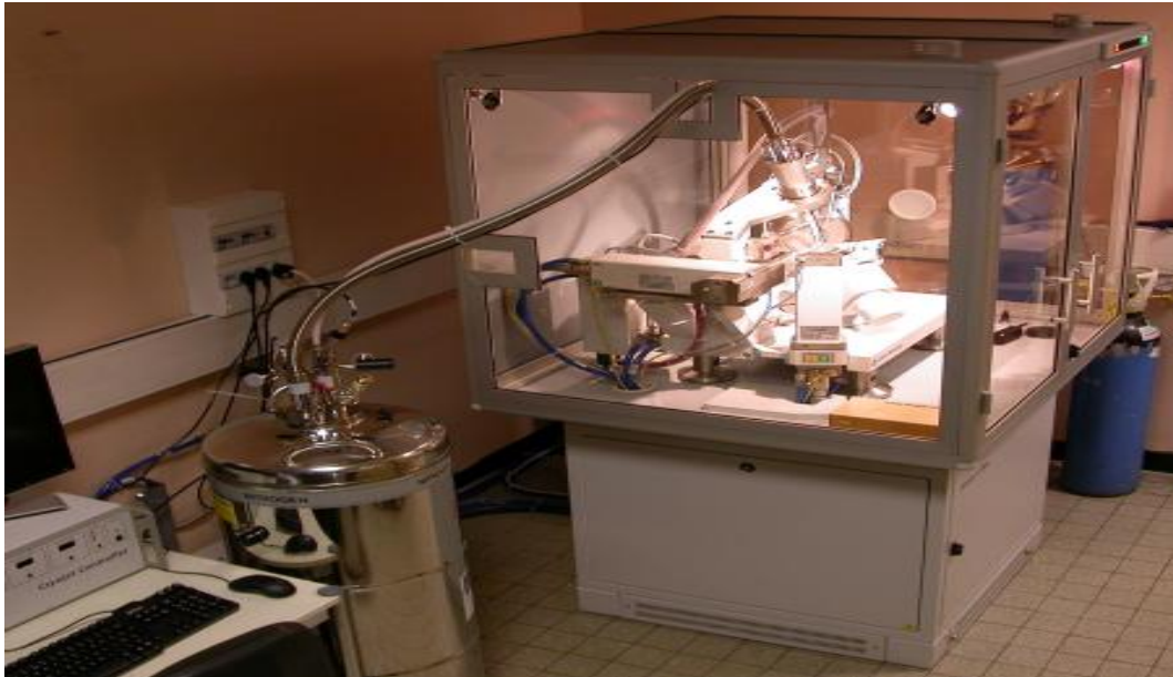
Figure IV. 1: Appareil d'analyse cristallographique par diffraction des rayons X[54].
