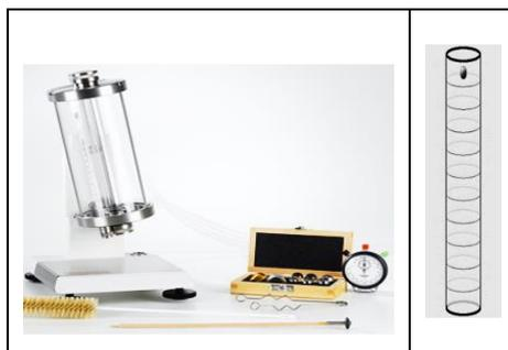
**Figure. 17** : Viscosimètre à chute de bille (Thermo).
