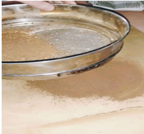
Figure 04 : Tamisage du sol.
