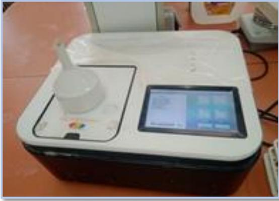
**Figure :** Spectrophotomètre UV/Vis.
