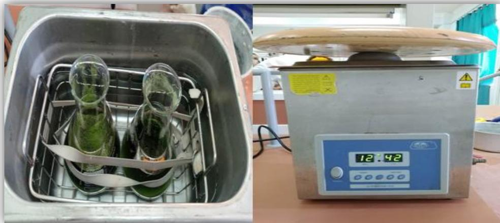
**Figure 15** : Extraction des principes actifs par ultrasons.
