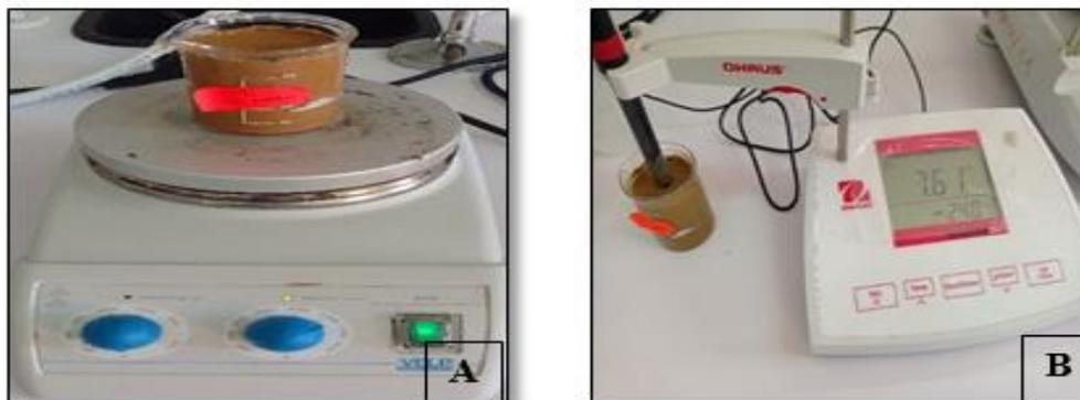
**Figure 9:** (A) L'agitation de la suspension ;(B) Mesure du pH avec un pH-mètre.
