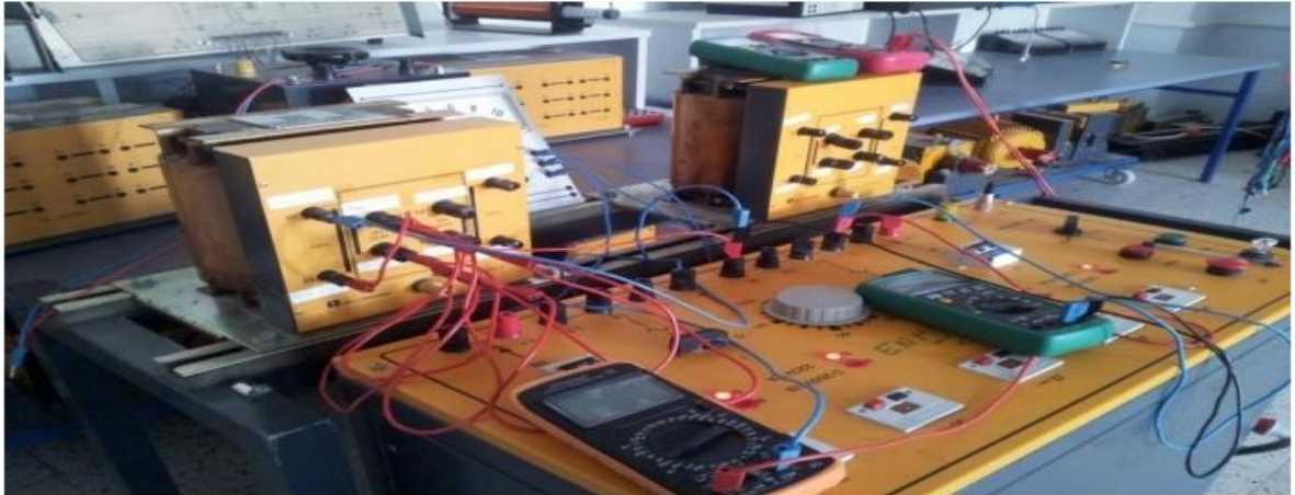
Figure III. 5 Montage de l'essai en court-circuit d'un transformateur monophasé
