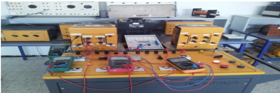
Figure III. 4 Montage de l'essai à vide du transformateur monophasé
