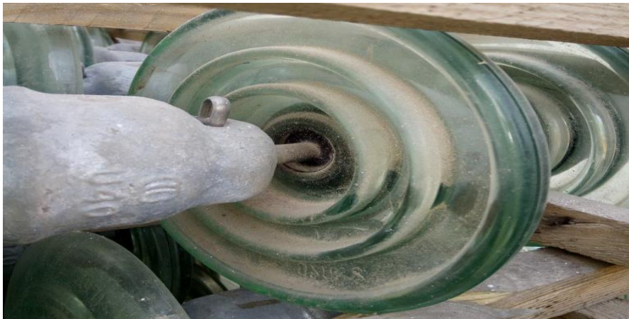
Figure I. 9 Photo d'un isolateur
