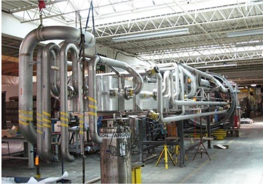
Figure IV.3 : Installation de liquéfaction d'hélium [20].
