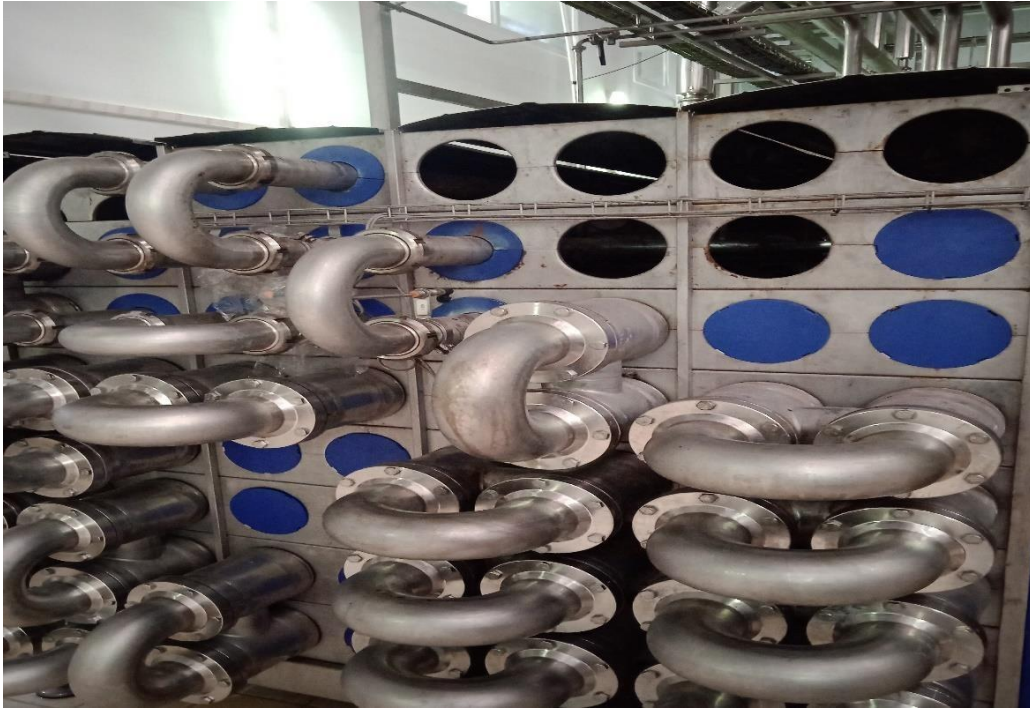
Figure I.8: Échangeur de chaleur tubulaire (Pasto)[1]
