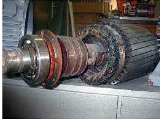
Figure I. 3: Rotor bobiné d'un MAS
