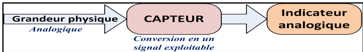
Figure I.3: Schéma bloc d'un système de mesure analogique [4].
