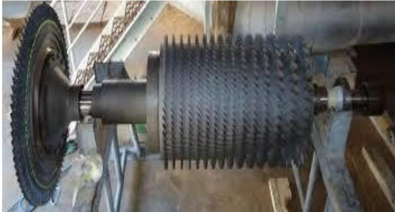
**Figure 18 :** Ensemble rotor compresseur /roue turbine HP [11].
