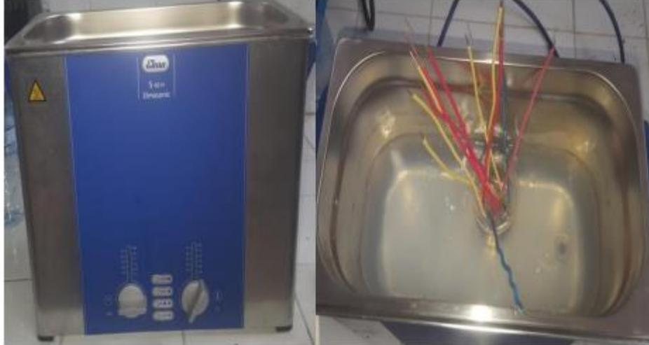
*Figure III.2: Appareil d'ultrason utilisé pour nettoyage des substrats.*
