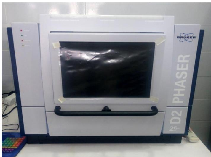
*Figure III.5: Diffractomètre Marque BRUCKER, Model D2 PHASER 2G*
