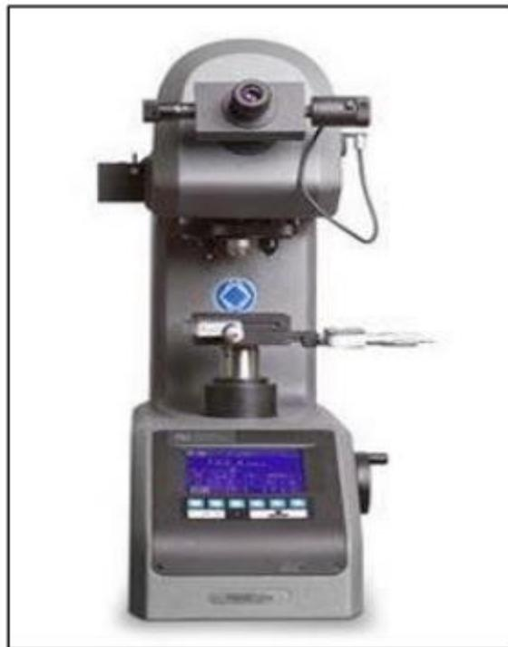
*Figure III.6: Microduromètre de marque Wilson hardness.*
