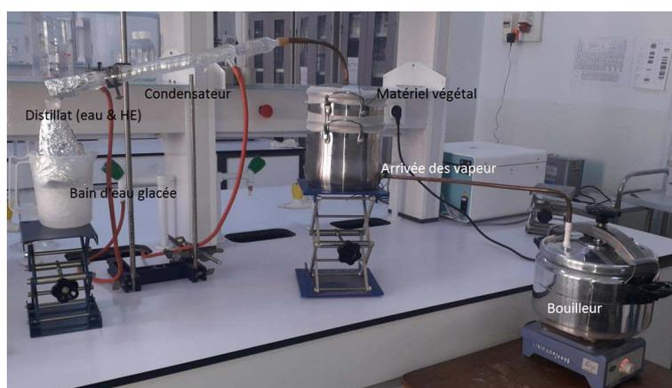
FIGURE 3.2: Schéma du dispositif expérimental de l'extraction d'huile essentielle (Alambic)
