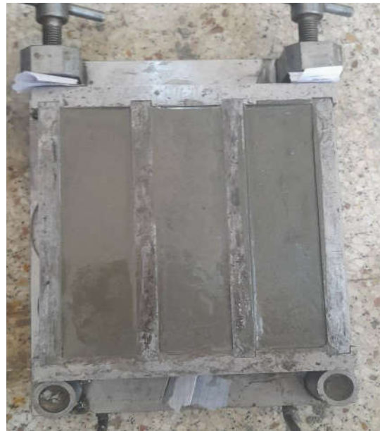
Figure IV.22 Malaxage et confection des éprouvettes
