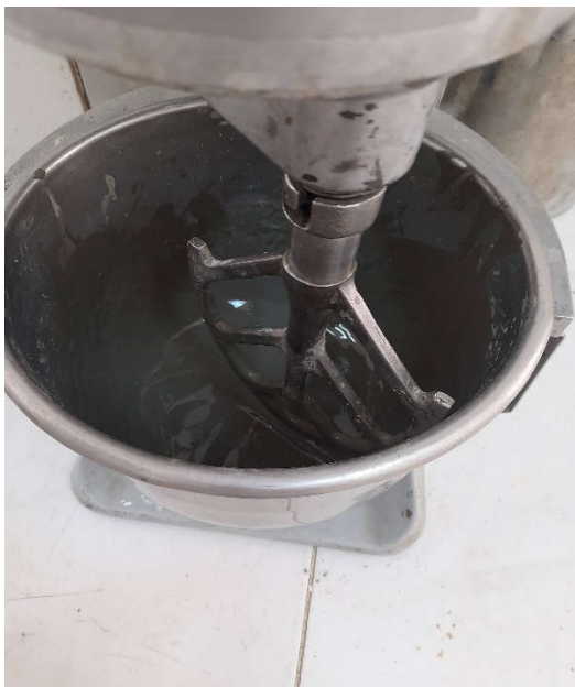
Figure IV.22 Malaxage et confection des éprouvettes
