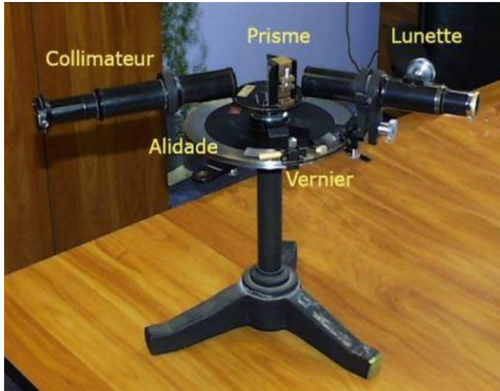
Figure 1.3 : Schéma du goniomètre.
