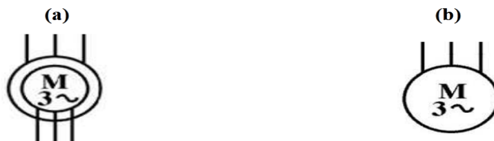
Figure (V-1-c) : Symboles électrique du MAS à rotor bobiné (a) et à cage d'écureuil (b).
