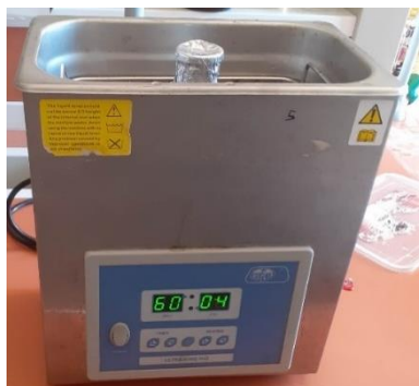
Figure 14: Extraction de la pepsine de poulet par sonication.
