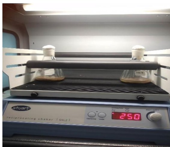
Figure 16: Processus d'extraction par le système d'agitation horizontale.
