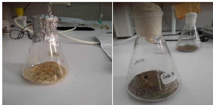
Figure 15: Production de la protéase fongique par M. circinelloides (aspect des Erlenmeyers avant et après la SSF).
