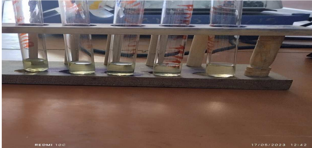
Figure 13 : Figure montrant l'apparition d'une couleur jaune qui révèle la présence de flavonoïdes (photo originale).
