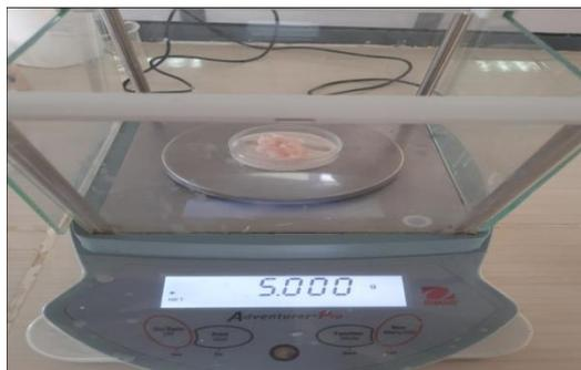
**Figure 80** : pèse d'échantillon dans le mélange.(photo personnelle).
