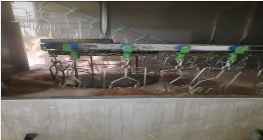
**Figure 53:** échaudoir à une T entre 52°C et 54° C (photo personnelle)
