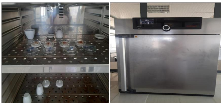
**Figure 81** : étuve à  $103^{\circ}\text{C} \pm 2^{\circ}\text{C}$ . (photo personnelle).
