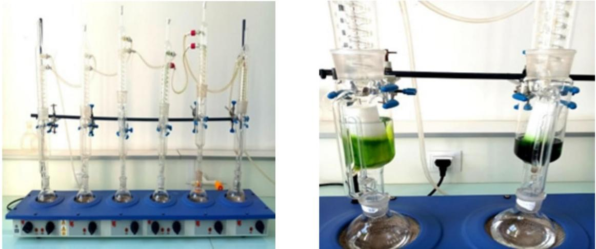
Figure 10 : L'extraction éthanolique par soxhlet (Originale, 2023)
