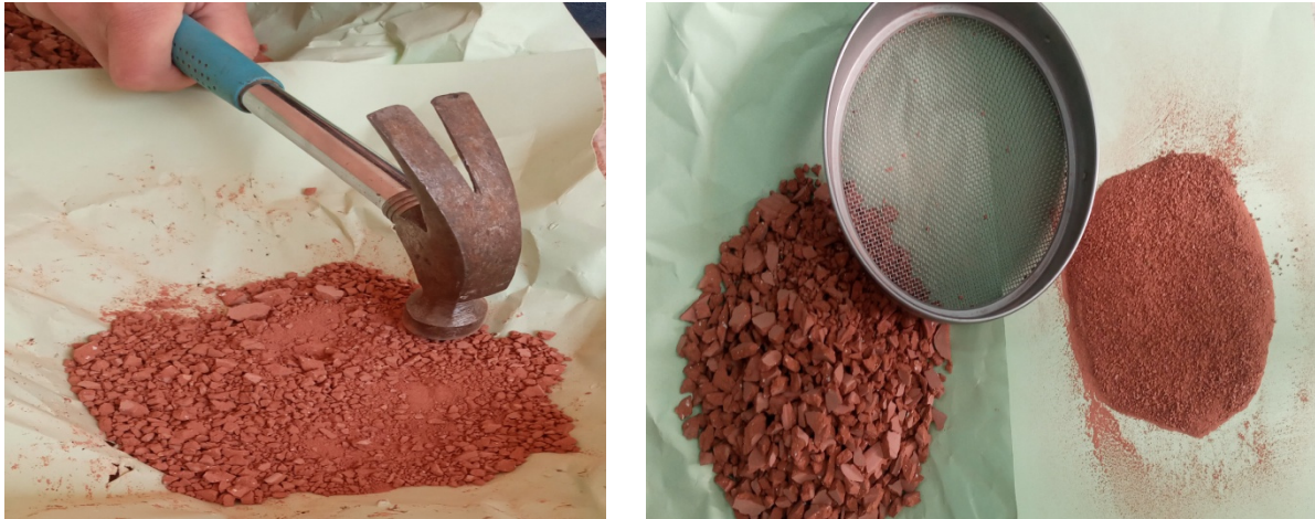
Figure 19: broyage manuel et tamisage de la brique
