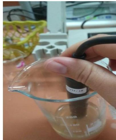
**Figure 4 :** Détermination de la conductivité électrique.
