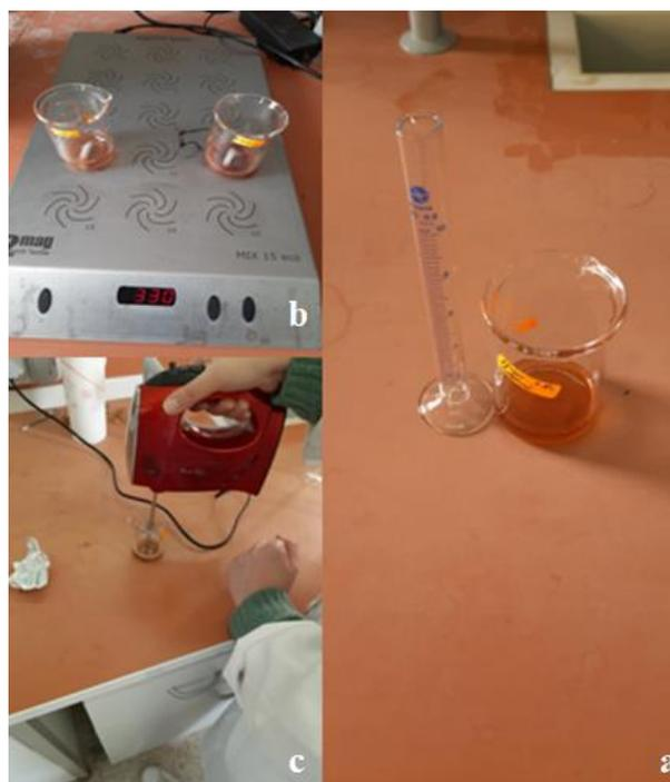
**Figure 06 :** Les étapes de la détermination de pouvoir et stabilité moussante ; (a) préparation des échantillons, (b) agitation avec un fouet, (c) mesure de volume de la mousse. Photo prise à grossissement (1844×4000).
