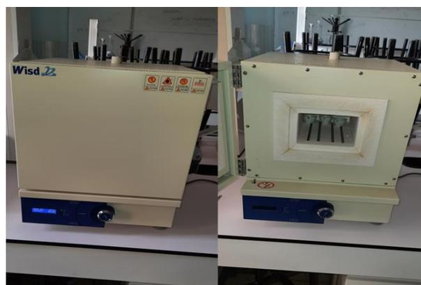
**Figure 03** : L'appareille de fourre à moufle pour la détermination de teneurs en cendre. Photo prise à grossissement (1844×4000).
