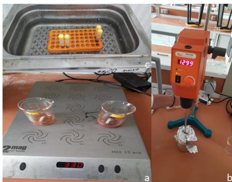
**Figure 07 :** Les principales étapes pour de terminer le pouvoir et stabilité d'emulsion ; (a) préparation des échantillons, (b) agitation avec un agitateur numérique vertical, (c) bain marie pour tester la stabilité d'emulsion. Photo prise à grossissement (1844×4000).
