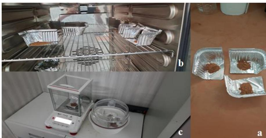
**Figure 04** : Les étapes pour la réalisation de test d'humidité. (a) ; mètre les échantillons dans des récipients, (b) le transfert dans l'étuve, (c) ; pesage. Photo prise à grossissement (1844×4000).
