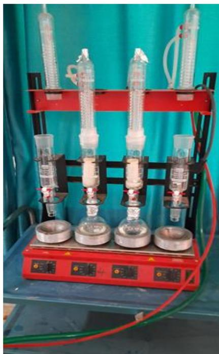
**Figure 05** : La figure montre le montage Soxhlet utiliser pour l'extraction du métier grasse. Photo prise à grossissement (1844×4000).
