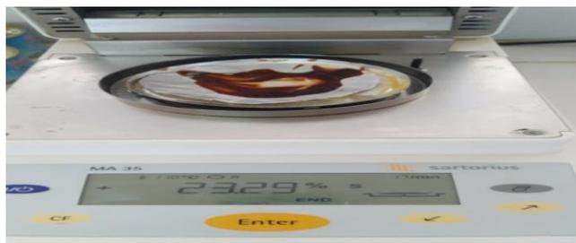
**Figure N°21**: Détermination de l'Extrait Sec Total par dessiccateur Infra-Rouge
