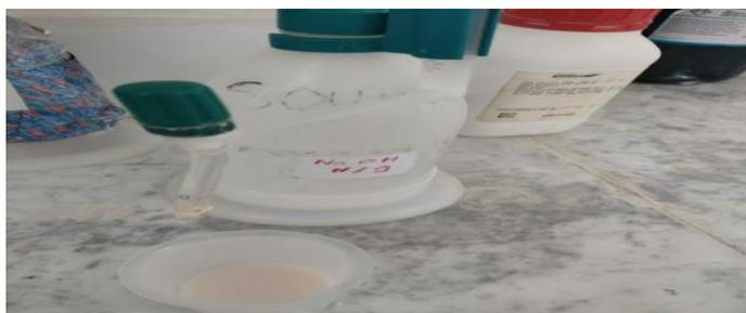
**Figure N°20** : Détermination d'acidité Dornic
