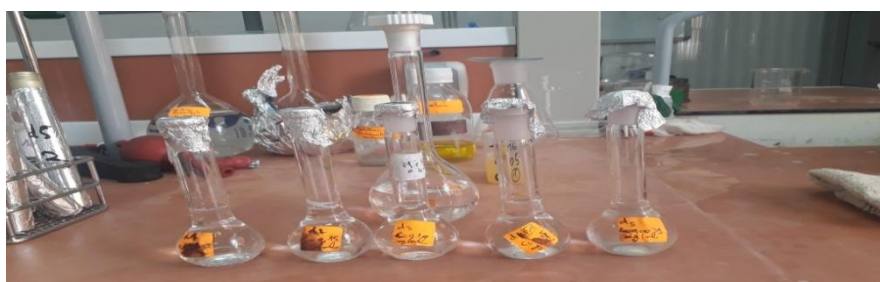
Figure 7 : Préparation des dilutions de la gamme d'étalonnage.
