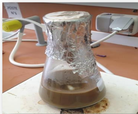
Figure 19 : Préparation de la suspension du sol
