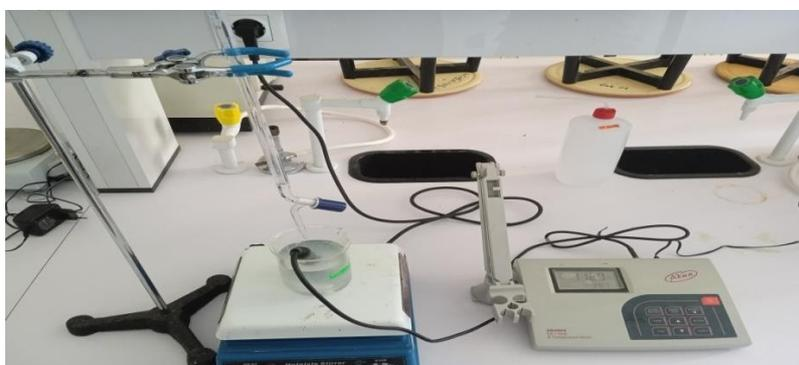
**Figure08** : Détermination de DDA par titrage conductimétrie
