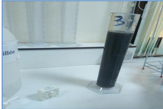
**Figure III.7**  $V_{30}$  avant la décantation.
