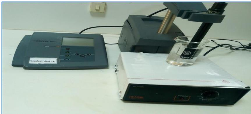
**Figure III.4** Conductivimètre (Source : auteur).
