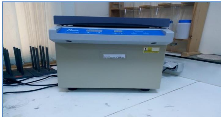
**Figure III.13** Centrifugeuse (Source : auteur).
