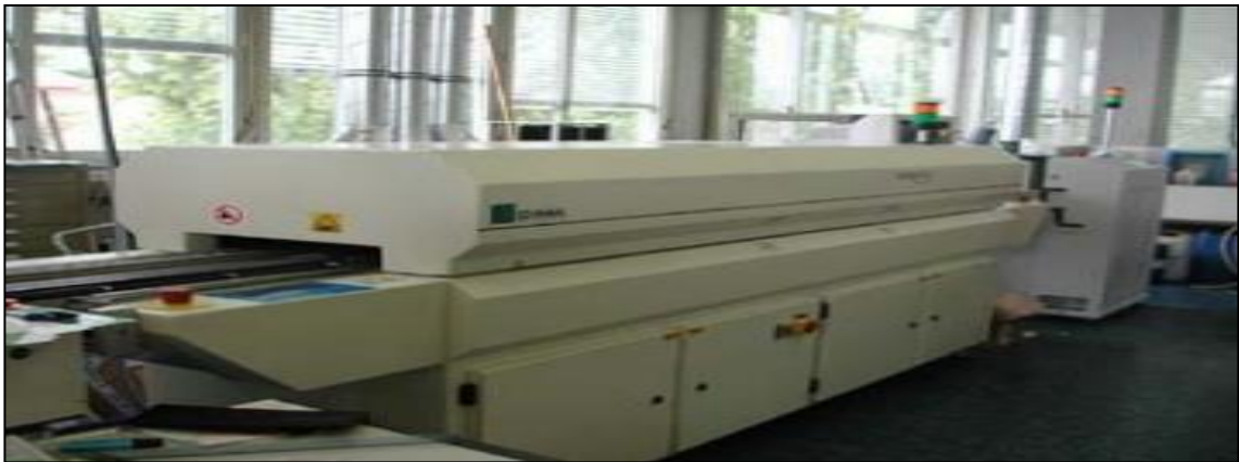
Figure. 1. 18 : Four de soudage[3].
