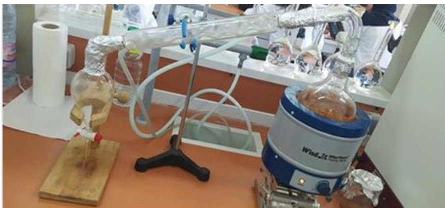
Figure 13 : Le montage d'hydrodistillateur de type Clevenger (Original)
