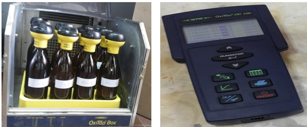
Figure II-4 : Dispositif d'agitation OxiTop box et OxiTop Controller OC100
