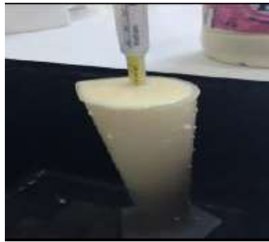
Figure 22 : Mesure de la densité par lactodensimètre ( originale )
