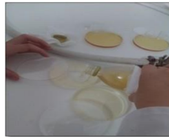
Coulage des boîtes.
