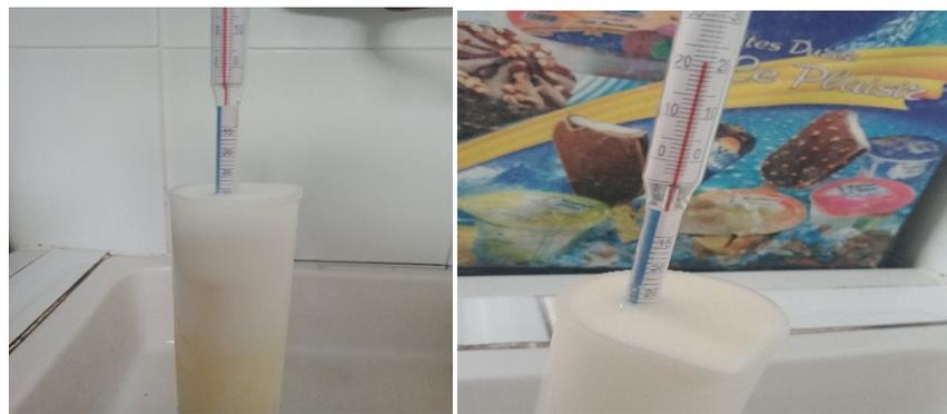
**Figure 18** :Résultats de la densité pour lait camelin (A) et lait bovin (B).
