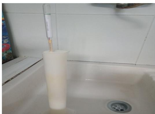
Figure 06: Détermination de la densité .
