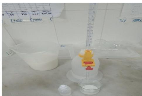
Figure 07: Détermination de l'acidité du lait.
