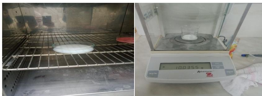
**Figure 08:** Détermination de la matière sèche .
