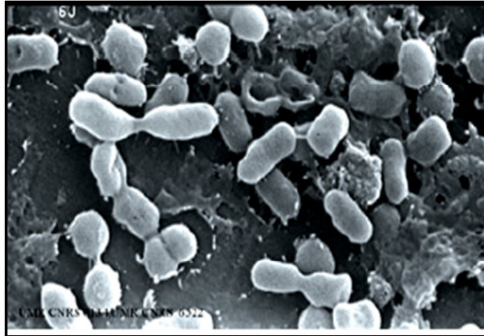
Figure 01. Biofilm de Legionella pneumophila formé sur de l'acier inoxydable Photographie prise au microscope électronique à balayage (Jouenne, 2008).
