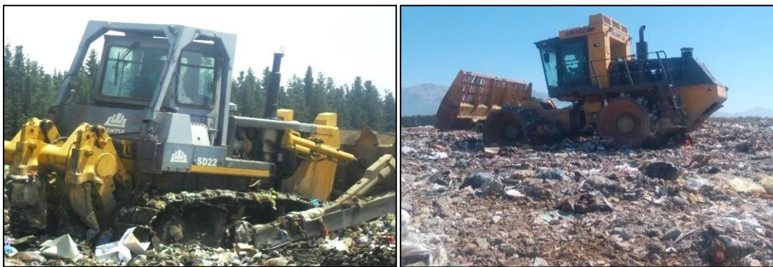
Fig. 15 : compactage et étalage des déchets
