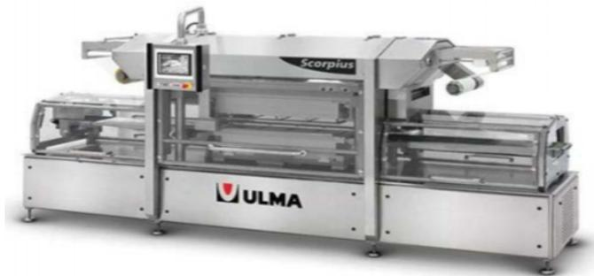
**Figure 07:**Operculeuse permettant un conditionnement sous atmosphère modifiée
