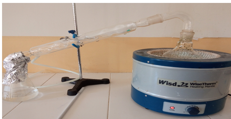
Figure 21 : Montage d'extraction de l'huile essentielle (Originale 2021)
