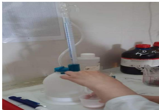
Figure n°22 : Dosage de l'acidité.
