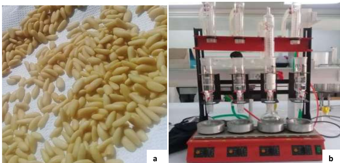
Figure 11: Photographies originales des graines sèches de P. pinea L. (a) et montage de soxhlet utilisé pour la délipidation (b).
