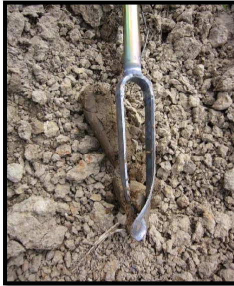
Figure 12. Modèle standard d'une tarière pédologique (Roebroek, 2009).
