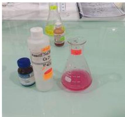
**Figure 09:** le résultat de virage de  $\text{Ca}^{2+}$  après titrage.
