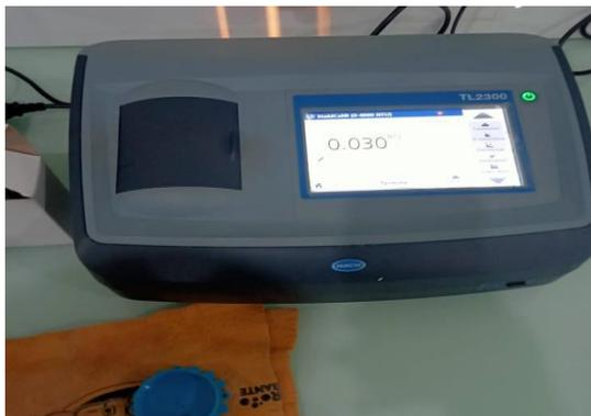
**Figure 08:** Turbidimètre
