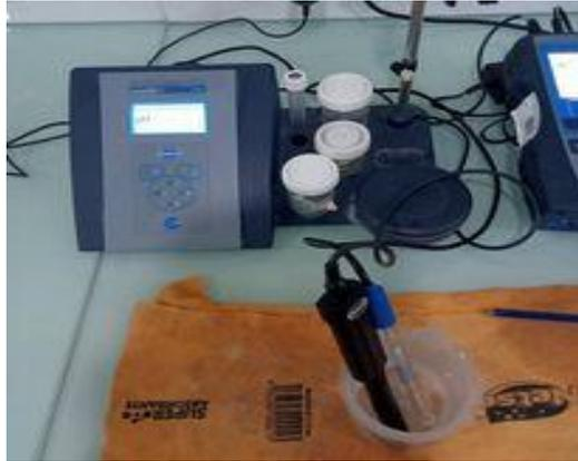
**Figure 07:** Conductimètre de mesure
