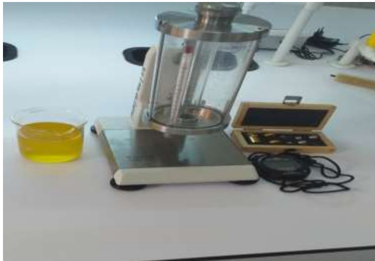
Figure 21: Préparation de viscosimètre à chute de bille.
