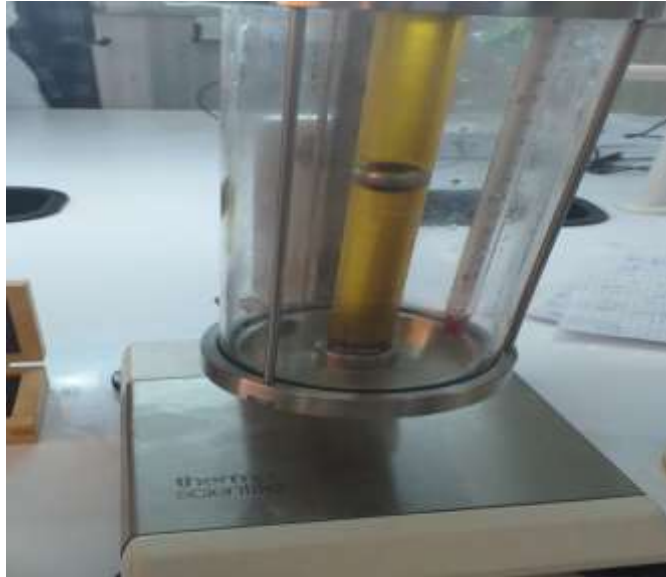
Figure 22: Chute de bille dans le liquide.
