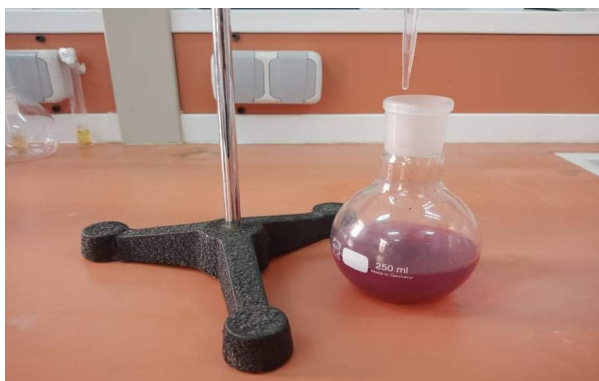
Figure 13 : Titrage de mélange (pectine +eau + NaCl +phénolphtaléine+ éthanol) par NaOH (Photographie originale, 2021).
