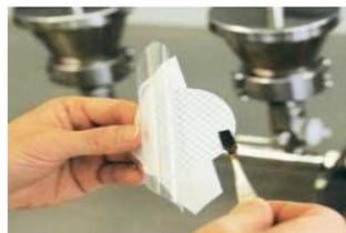
2-Déposer les membranes 0.45µm dans la rampe
