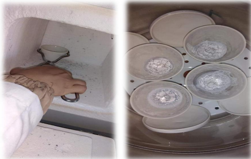
Figure 14 : Photographie représentant (a) les creuset pendant placé dans un four à moufle, (b) après 2h placé les creusets refroidis dans un dessiccateur .
