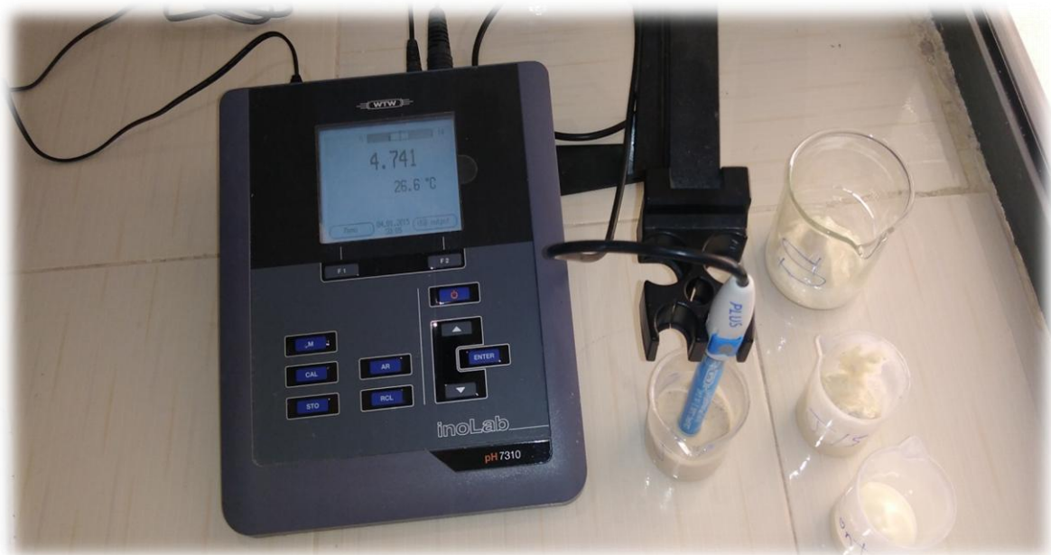
Figure 10 : Photographie de détermination de pH de yaourt enrichi par le pH-mètre
