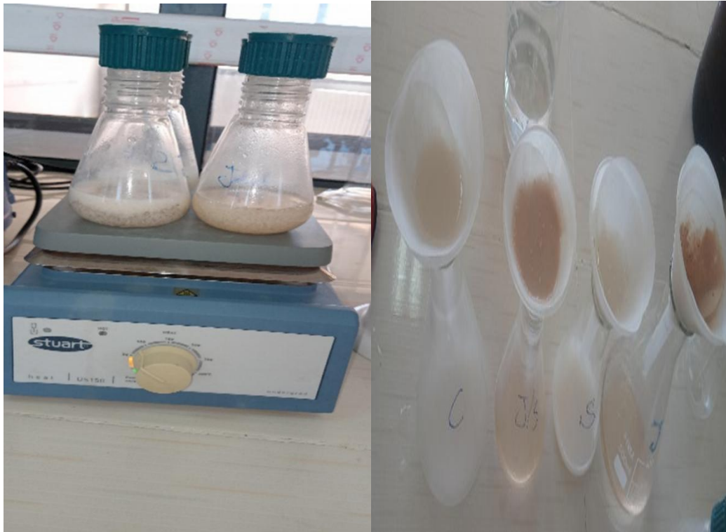
Figure 15 : Photographie des échantillons pendant préchauffage et filtration
