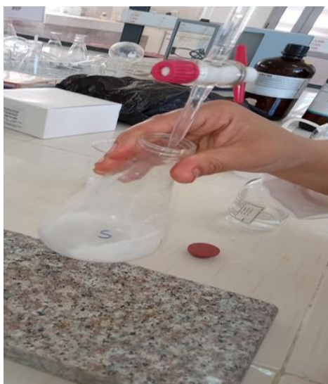
Figure 12 : Photographie de détermination de l'acidité titrable
