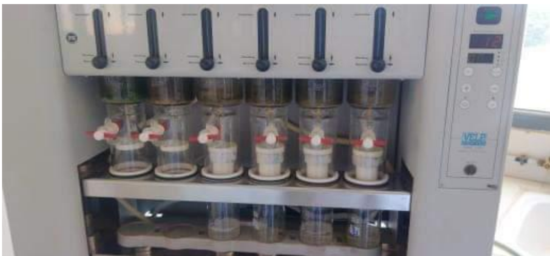
Figure 16 : Photographie de détermination des lipides par extraction au Soxhlet
