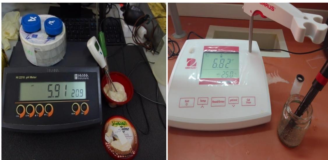
*Figure 07 : Photographiée de la mesure de ph (grain/produit fini)*
