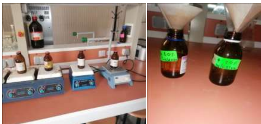
Figure 7 : Photographies des étapes d'extraction par la méthode de macération
