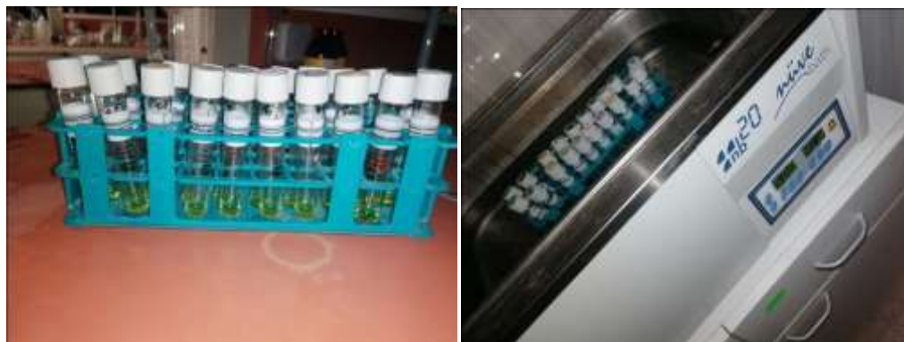
Figure 9 : Photographies des étapes de préparation du dosage de pouvoir réducteur ferrique
