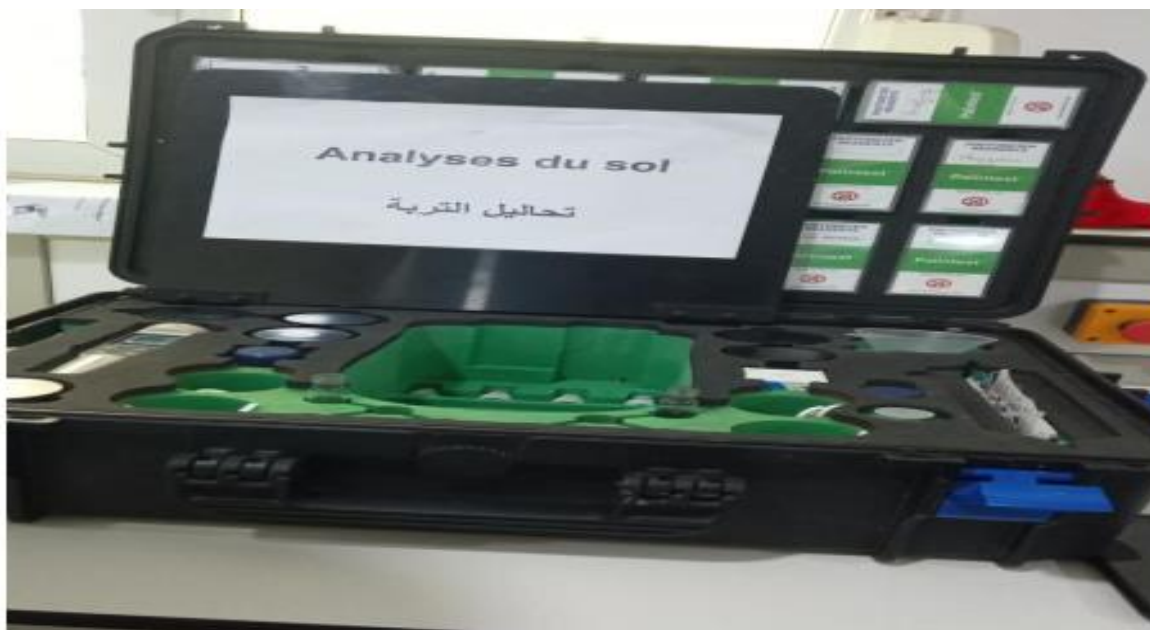
Figure 17: Palin test pour les analyses chimiques (photo original).
